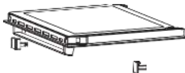
Демонтаж внутренней стеклянной панели
